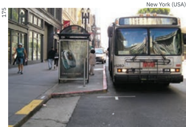
Zastávka v jazdnom pruhu riešená ako vynechanie parkovacích miest slúži na spomalenie dopravy.
