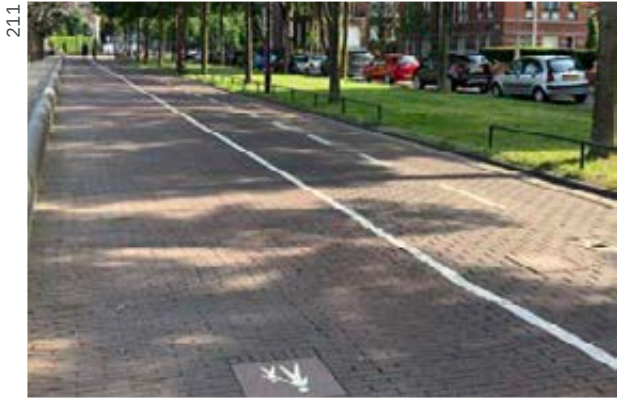
Prírodný kameň / betónová dlažba → Oddelenie farbou, alebo ukladaním dlažby
