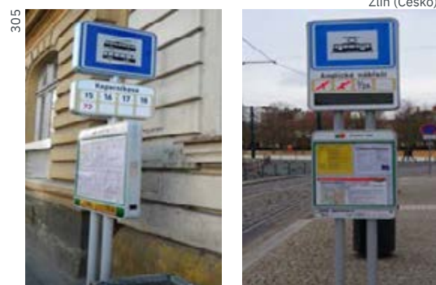
Modulovateľný označník na dvoch stojkách s e-tabuľou Materiál: kov, sklo, plast
