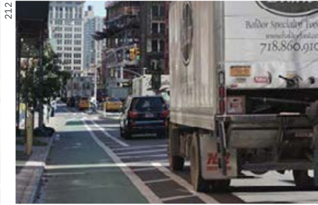
Pásky na vozovke → Farebný pruh s bezpečnostným odstupom od parkujúcich áut
