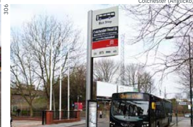
Modulovateľný označník na jednom stĺpiku Materiál: kov, sklo, plast
