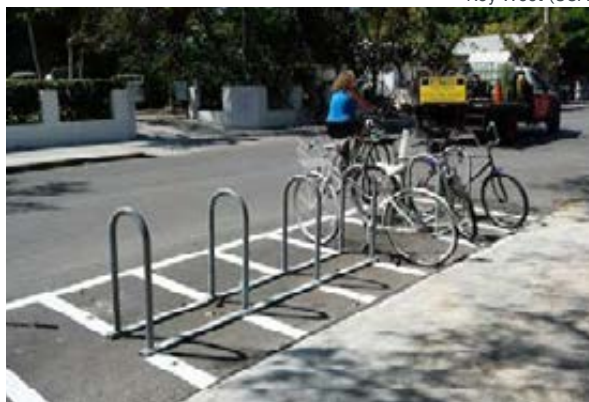
Sústava stojanov s funkciou upokojenie dopravy materiál: kov pozink / neutrálna farba
